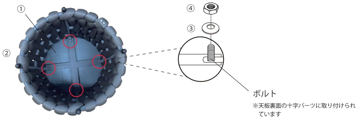
ステップ2：脚部のアジャスターでガタツキの調整をします。
