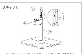
①パラソル本体を、②パラソル支柱と穴位置を合わせた状態で差し込み、⑭支柱固定用ボルト2本を用いて固定します。パラソルの組立は完成です。
