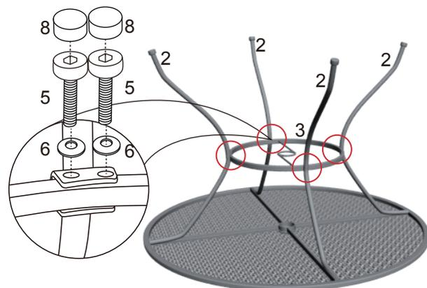
図のように、⑤六角穴付ボルトと⑥ワッシャーを使用し、丸で囲ってある拡大図のように③センターコネクタを②脚の中央部に合わせて固定してください。
